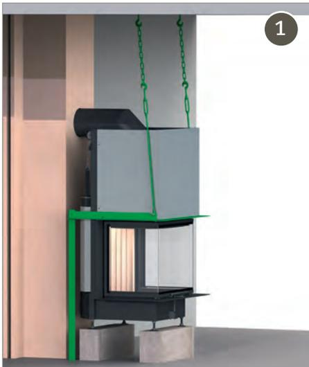
Anbaurahmen (grün) mit Zugankern an Decke befestigt als Auflager für raumhohe Kaminhülle. Statisch abgestützt zum Boden für zusätzliche, hohe Belastung (bauseits).
